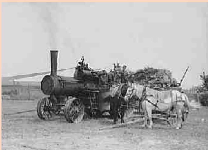
*La machine à vapeur allait de ferme en ferme pour battre les gerbes*
